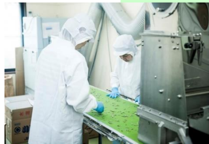
異物除去作業
