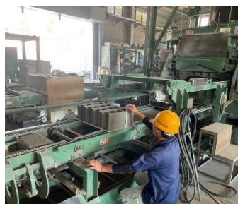
コンクリートブロックの製造
