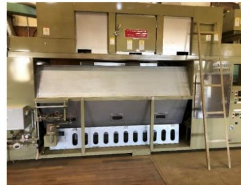
落合式マイクロ波ガス遠赤外線乾燥火入機
