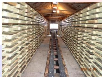
澱粉粕を原料とする固体培養方式の醗酵室
