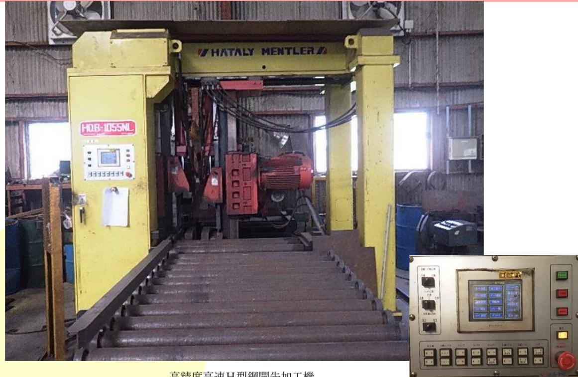
高精度高速H型鋼開先加工機
